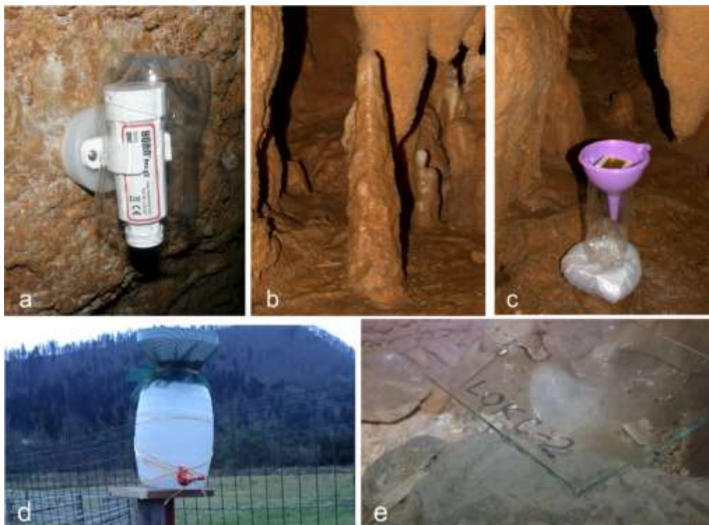
Slika 2. a) TH logger; b) aktivna siga MOD-31 koja je uzeta za analize; c) drip-logger postavljen na mjesto uzorkovane sige MOD-31; d) prikupljanje kišnice u Lokvama; e) prikupljanje recentnog kalcita u Lokvarci.
