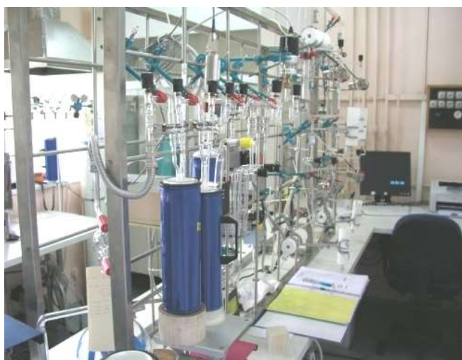
Vakuumska linija za pripremu grafita za 14 C-AMS u Laboratoriju za mjerenje niskih radioaktivnosti Instituta Ruđer Bošković, Zagreb
