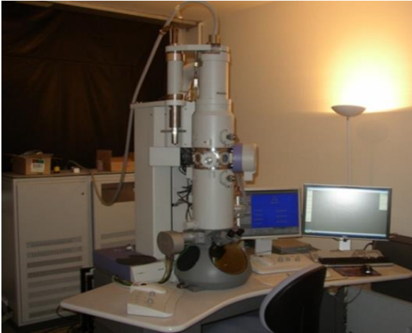
MET 120 kV Tecnai12
